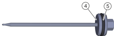
Obr. 18: Výměna těsnění pístu
